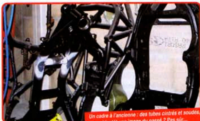
Un cadre moderne est composé de parties moulées, ici à l'avant et à l'arrière pour ce CBR 1000, et un morceau de profilé au milieu, que fait-il là d'ailleurs ? Une pièce chère et complexe.
