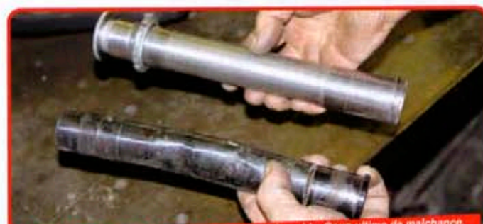
Notre pivot de direction est bien amoché, et pas réparable. Coup ultime de malchance, la pièce n'existe pas seule chez l'importateur. La solution ? En fabriquer un neuf (à droite), c'est trois fois moins cher...
