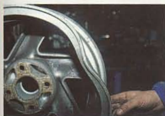
La partie choquée est examinée avant toute intervention.
